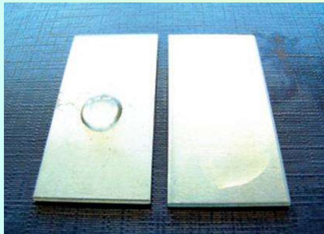
Visualisation de l'épreuve de chute d'eau, avant et après le nettoyage d'une feuille d'aluminium
