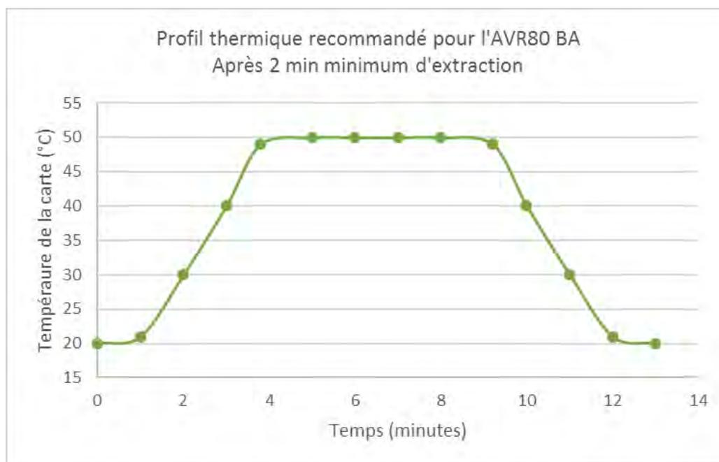
Ce profil thermique peut être adapté ( $\pm 10^{\circ}\text{C}$ , en fonction de différents paramètres : épaisseur déposée, design de la carte, ...).
