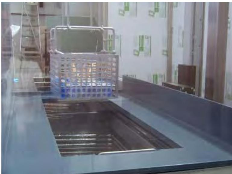
Le séchage rapide étant donné son point d'ébullition optimal (29°C), permet de traiter et d'utiliser les pièces immédiatement en sortie de nettoyage.
